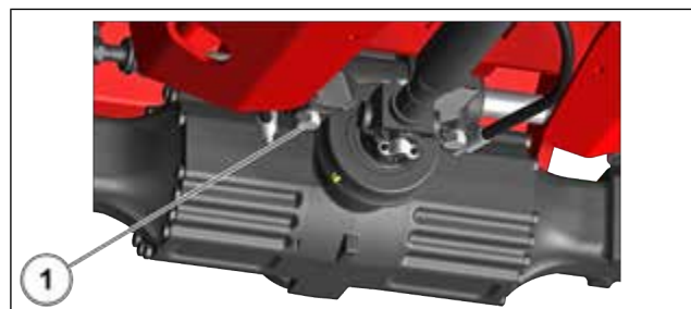
Illustration 131: Kontrol af akslernes tilspænding 2
