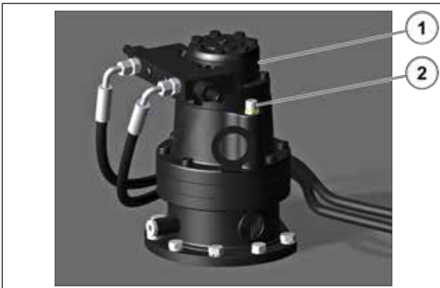
Illustration 142: Kontrol af oliestanden i motoren til drejeskivens rotation 1
