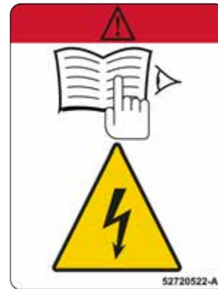
Figur 25: Mærkat - fare, risiko for livstruende elektrisk stød
