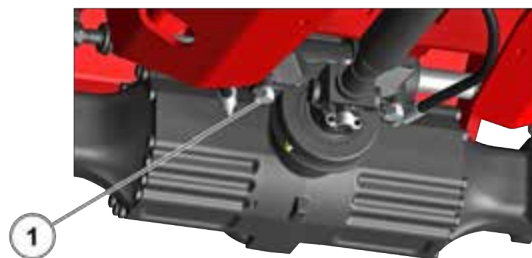
Figur 133: Kontrol af akslernes tilspænding 2
