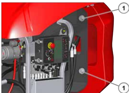
Figur 174: Kontrol af kontravægtens tilspænding 1
