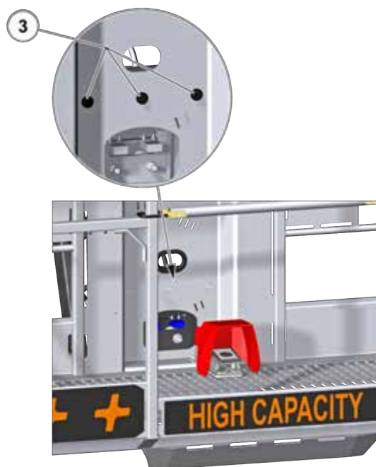
Figur 163: Kontrol af platformens tilspænding 3
