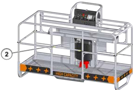
Figur 127: Kontrol af elektrisk 230V-stikkontakt på platformen 2
