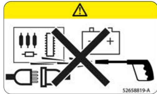
Figur 21: Mærkat - risiko for kortslutning
