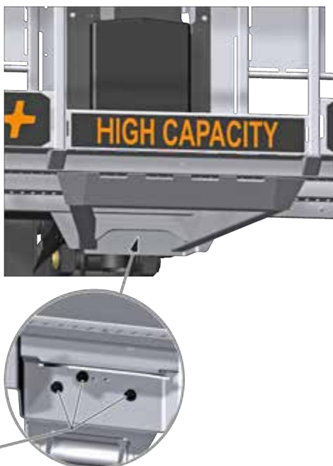
Figur 161: Kontrol af platformens tilspænding 1
