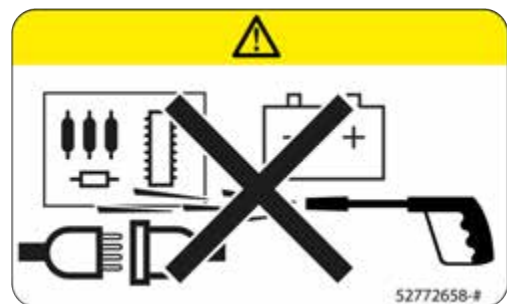
Figur 35: Mærkat - risiko for kortslutning
