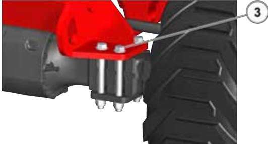
Figur 135: Kontrol af akslernes tilspænding 4
